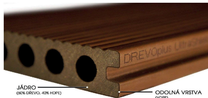
Detail složení materiálu DŘEVOplus® PROFÍ UltraShield®
